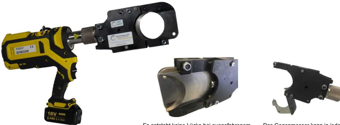
Es entsteht keine Lücke bei ausgefahrenem Schneidmesser. Finger können beim Rücklauf nicht eingeklemmt werden
