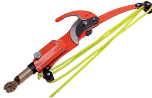
Der Kopf der Astschere besteht aus einem stationären und einem beweglichen Messer, welche aus gehärtetem Stahl gefertigt sind. Durch die spezielle Konstruktion der Schere, hat diese ein Übersetzungsverhältnis von 3:1, d.h. 5kg Zug am Seil ergeben am Schneidkopf eine Kraft von 15kg. Der Anwender hat somit den Vorteil, die Schere mit verringertem Kraftaufwand bedienen zu können. Kugelgelagerte Seilrollen garantieren einen reibungslosen Arbeitsverlauf.
